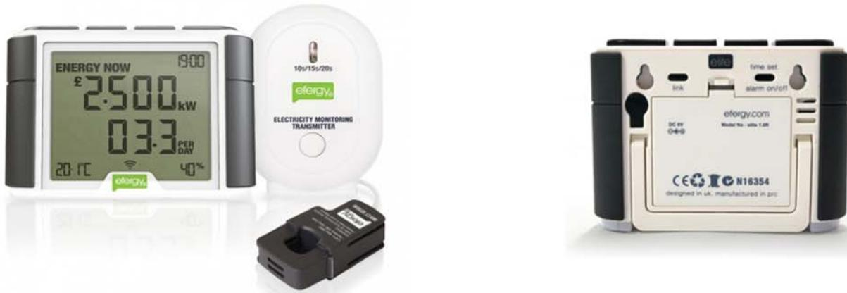
Un minisensor CT se abraza al cable fase de tu cuadro eléctrico. El cable sensor y el adaptador se conectan al transmisor, que envía los datos de forma inalámbrica y en tiempo real al monitor de energía. El monitor convierte los datos y te muestra la demanda en kilovatios de energía consumidos en cualquier momento dado.
