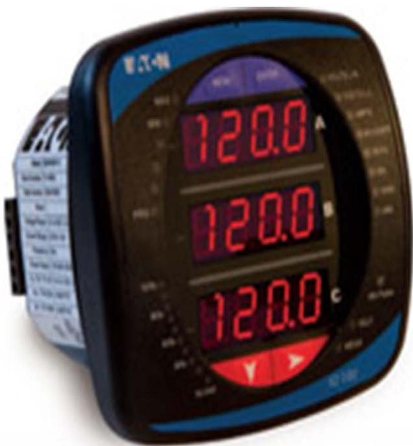
Los medidores de la serie IQ 130/140/150 proporcionan valores medidos de lectura directa para los aspectos más críticos de la energía, por ejemplo, potencia (W), demanda de potencia (W), vatios-hora, voltiamperios (VA), VA-hora, voltiamperios reactivos (vars), var-hora y factor de potencia. Con precisión que responde a la norma ANSI C12,20 (0,5 %), estos medidores se pueden usar con confianza para la tarificación primaria de medida y las aplicaciones de submedición en secundarias.
