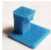
Imagen 11. Pruebas de sujeciones para cables con material ABS.
